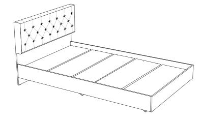
Габаритные размеры Ширина (мм): 1240 Глубина (мм): 2036 Высота (мм): 890
